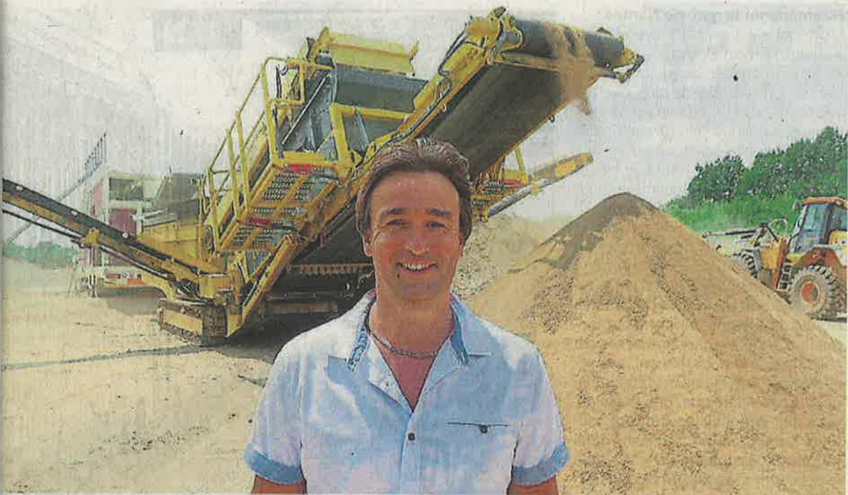
Derrière Sébastien Philippe, patron de quatre-vingts salariés au Cellier, en Loire-Atlantique, le « crible » débite des gravats recyclés en trois calibres différents.
